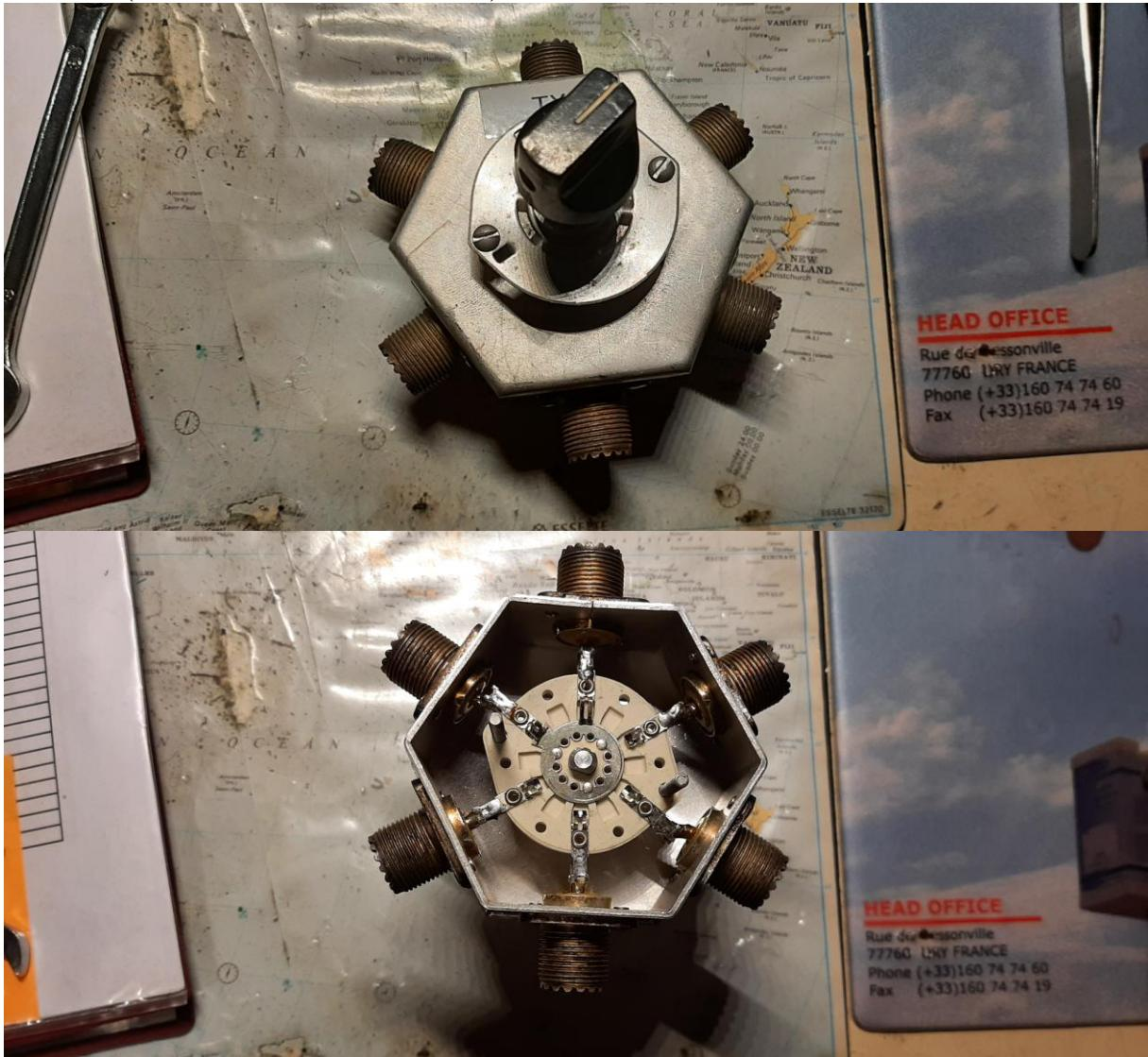
Avantages de ce modèle : plus grand nombre de sorties ( dont une vers une charge 50 Ohms pour les réglages) , une position de mise en court-circuit de la totalité , y compris la sortie vers le TX .
