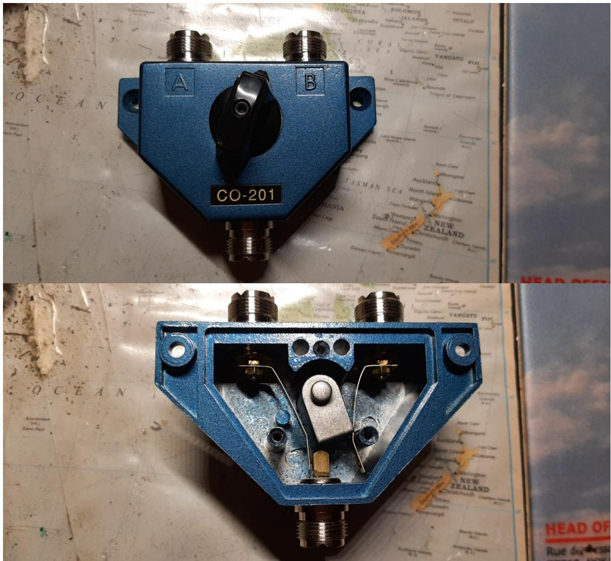
Avantages : son prix est modique, pas d'électronique , l'antenne non utilisée est en court-circuit à la masse, construction robuste et facilement accessible .
