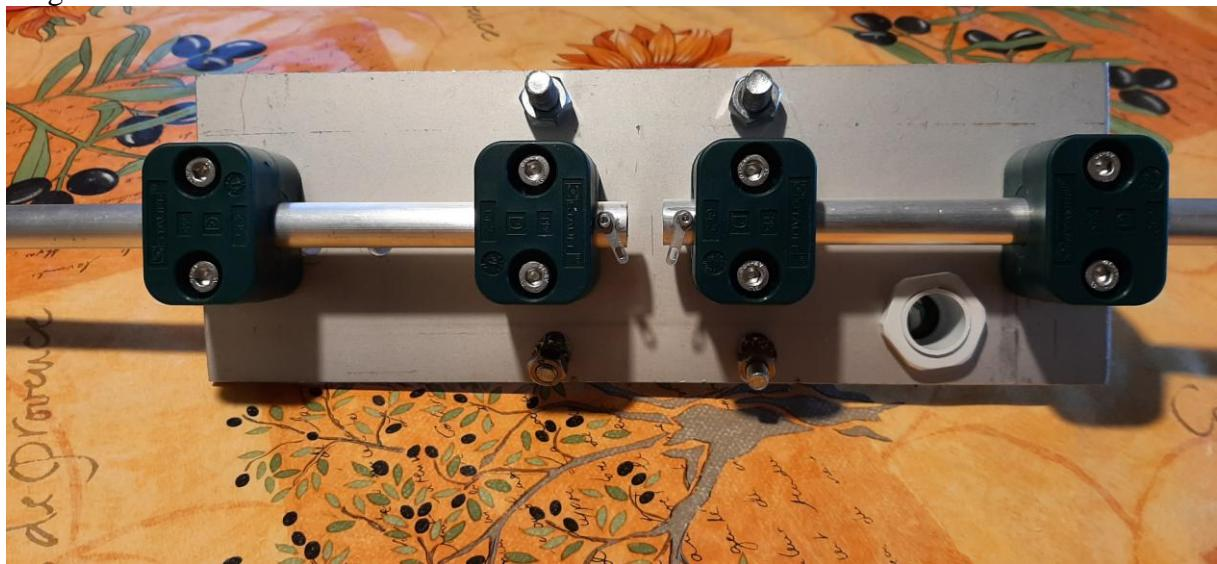
Le tube support de l'antenne étant un mât de planche à voile, les brides sont de diamètre 50 mm. Le serre-câble gris est destiné à fixer le coaxial de 75 Ohms et éviter les efforts sur les connexions .
