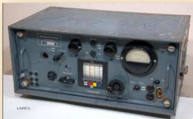
Le récepteur « Samos » FuMB 4 (source LA6NCA)
