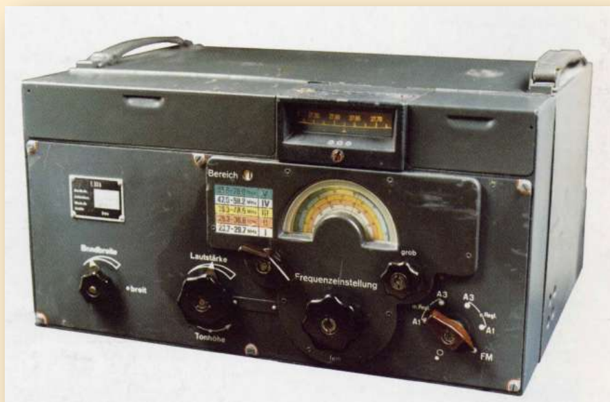
Récepteur Telefunken E52 « Köln ». Source : www.carlobramantiradio.it
