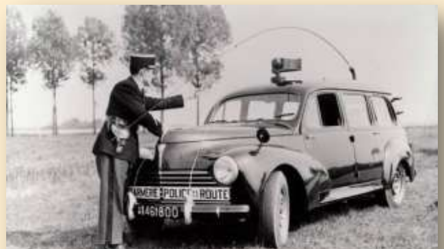
Peugeot 203 équipée Public-Adress. Le gendarme est en train de rabattre le fouet vertical de 5m afin de reprendre la route. (Source : http://aptg.forumprod.com/ )
